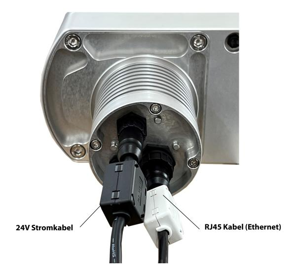
Die Ferritelemente werden an den Kabeln nahe der Kamera montiert. Eine Montage auf der gegenüberliegenden Kabelseite ist möglich, bringt aber für die Kamera weniger Vorteile.
