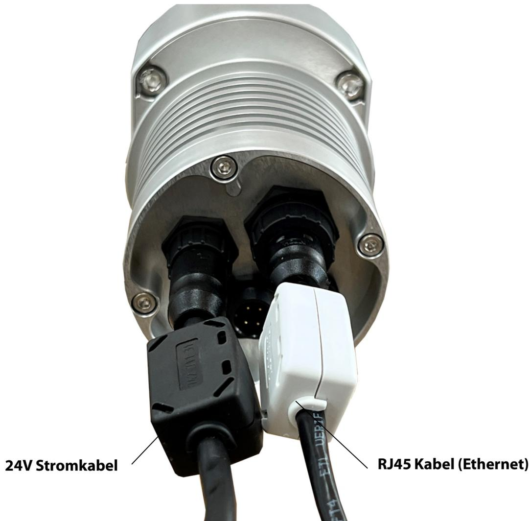
**Die Ferritelemente werden an den Kabeln nahe der Kamera montiert.** Eine Montage auf der gegenüberliegenden Kabelseite ist möglich, bringt aber für die Kamera weniger Vorteile.
